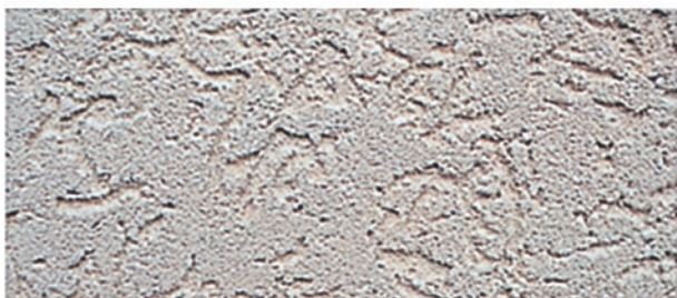
Figuur 5.2 Structuurpleister Pleister met schorseffect, korrel 2 - 3 - 4 - 5 mm
