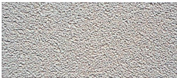
Figuur 5.1 Spachtelpleister Pleister met een rustig en regelmatig oppervlak, korrel 1,5 - 2 - 3 mm
